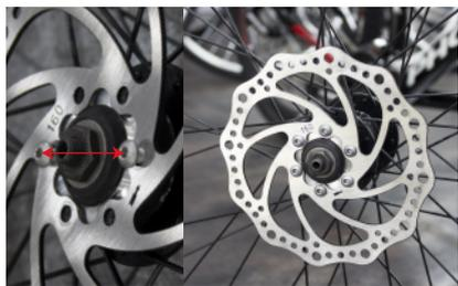
**步骤 6** 安装前轮碟盘，对角拧上所有螺丝后同时对角锁紧(扭力：4-6N)
