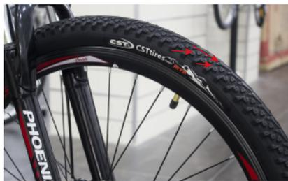
**步骤 7** 将前轮架上前叉，注意轮胎的方向，通常在胎壁上会有标示，若没有的话就从胎纹的走向来判断，从上方看的尖锐处朝前或者轮胎商标一侧朝转动侧。
