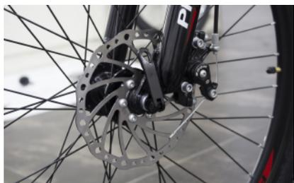
**步骤 8** \* 安装快拆柄的位置在车子的左侧(非传动侧)。请确认轮轴有完全进入勾爪之中，轮子在中心位置并上锁将快拆柄垂直向上合紧或水平地面向后合紧(扭力：松脱力 50N↑板紧力 200N↓)(前/后花鼓螺母扭力：3-40N)
