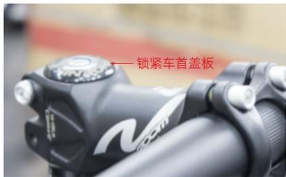
**步骤 10** 车首龙头平衡因两点一线，前轮轮胎中心与把立中心一条线。先锁紧车首盖板至车首组件无松动或左右转动自然顺畅(扭力：4-6N)，再锁紧把立(扭力：10-15N)
