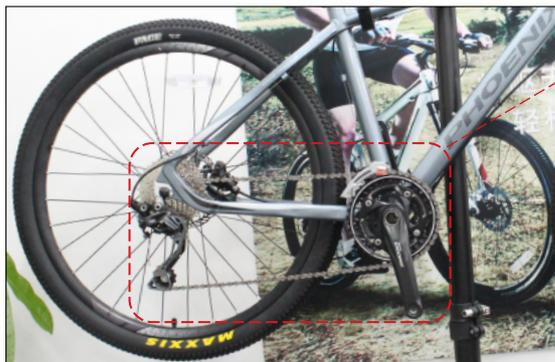
● 展架上自行车牙盘、飞轮朝外侧摆放。前拨放最大, 后拨放最小, 水平张力状态, 曲柄和车架中管一条线。
