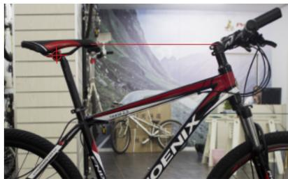
**步骤 11** 座垫调整，所有车辆的座垫全部调至水平，座垫前后以座杆夹在座弓当中为标准
