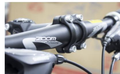
步骤 5 安装把横: 标志应水平与地面并向前, 四颗螺丝对角并循环拧紧(扭力: 10-15N), 把立前盖上下间隙需均等,
