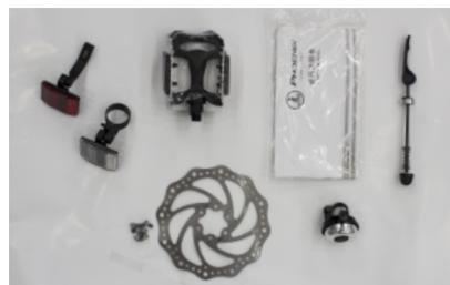
步骤 2 碟刹快拆整车检查配件盒内配件 (快拆、前/后反光镜、脚踏、车铃、碟片)
